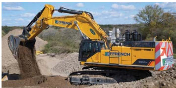
Notre nouveau godet pour pierres extra-robuste est fabriqué dans des plaques en acier résistantes à l'usure et extrêmement solides. Il est parfaitement adapté aux rigueurs de l'exploitation minière et en carrière tout au long de son cycle de vie.
