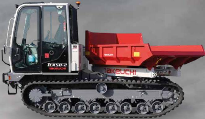
Le tombereau sur chenilles TCR50-2 fait son entrée dans l'assortiment Takeuchi. Il se prête particulièrement bien au transport dans des lieux difficiles d'accès, comme des terrains très humides. Ou des zones de construction où la pression sur le sol doit rester limitée. La machine est pourvue d'un moteur avec FAP, SCR (AdBlue) et d'un DOC. La machine est également équipée de série de:
