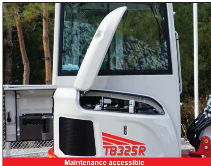
Les Points clefs des éléments de maintenance sont accessibles facilement
