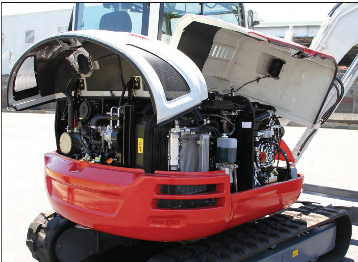
Larges capots métallique et robuste pour une accessibilité et une robustesse sans failles
