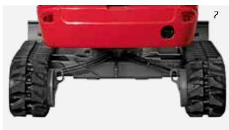
LARGEUR DU TRAIN DE ROULEMENT DÉPLOYÉ 1.300 MM
