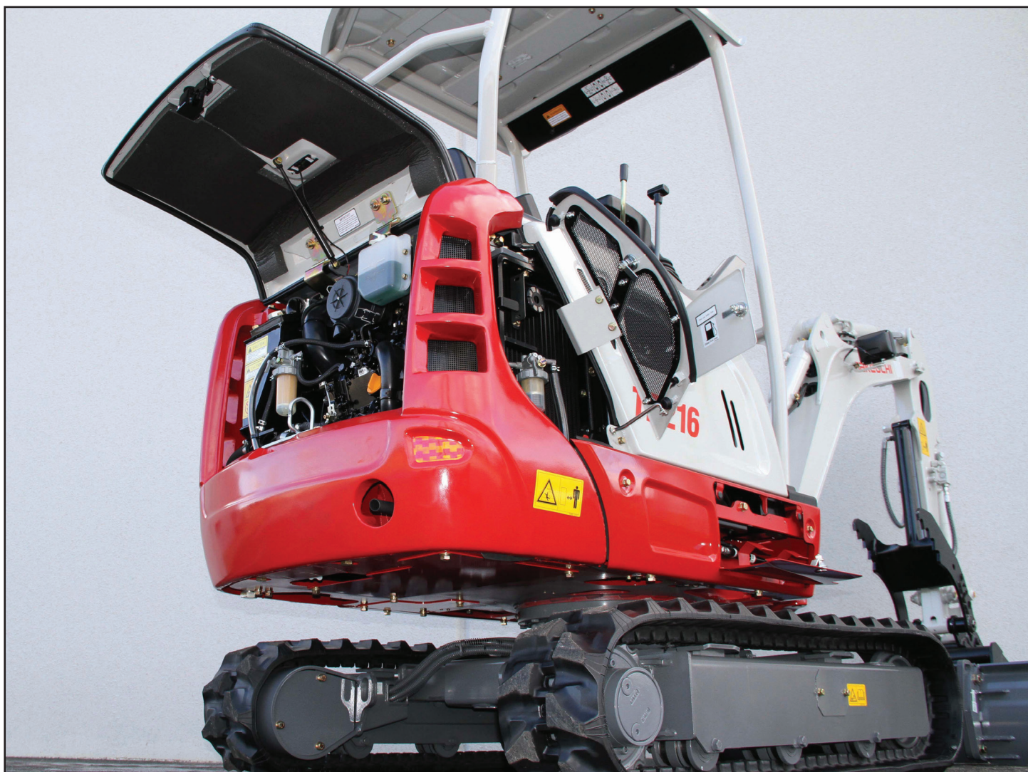
Facilité d'accès pour l'entretien et la maintenance
