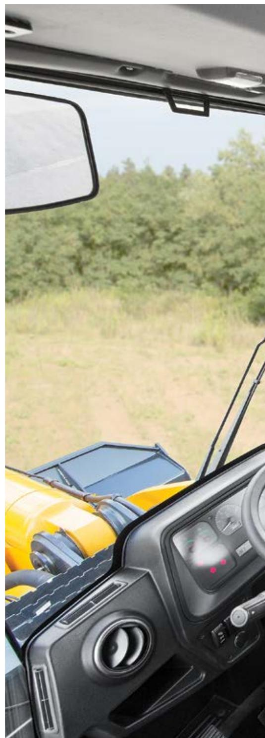
La cabine protège l'opérateur du bruit et des vibrations et est bien ventilée. Le contrôle avancé de la température permet un réglage précis en toutes saisons, dans une cabine hermétique et pressurisée afin d'empêcher l'intrusion de poussière.
