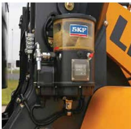
Un système de graissage automatique en option améliore la durée de vie des roulements et réduit les réparations en fournissant des quantités régulières et précises de graisse à chaque roulement.
