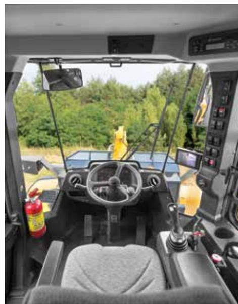
La cabine protège l'opérateur du bruit et des vibrations en plus de la ventiler. Elle dispose d'un système de climatisation avancé, adapté à toutes les saisons, et reste totalement hermétique à la poussière sur le lieu de travail.
